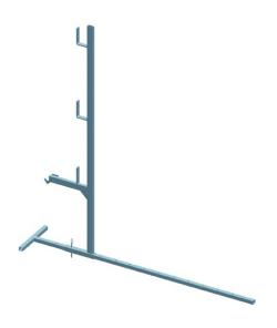
Les gardes-corps se fixent en rive ou en bas de toit et reçoivent les accessoires de sécurité (lisses, plinthes, filets) pour constituer une protection complète.
