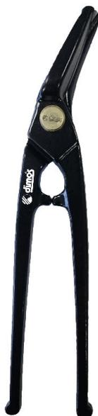
Grâce à leur tranchant plus réduit, les cisailles bichantourneuses permettent d'effectuer des découpes très précises en ligne droite ou en courbe. Elles sont particulièrement adaptées pour les angles précis et pour amorcer des découpes.
