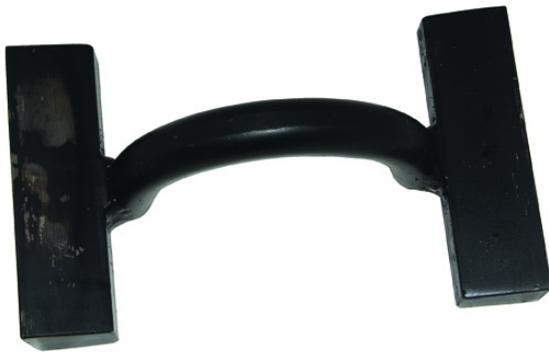
La main de fer carrée est utilisée pour le façonnage du joint debout.
